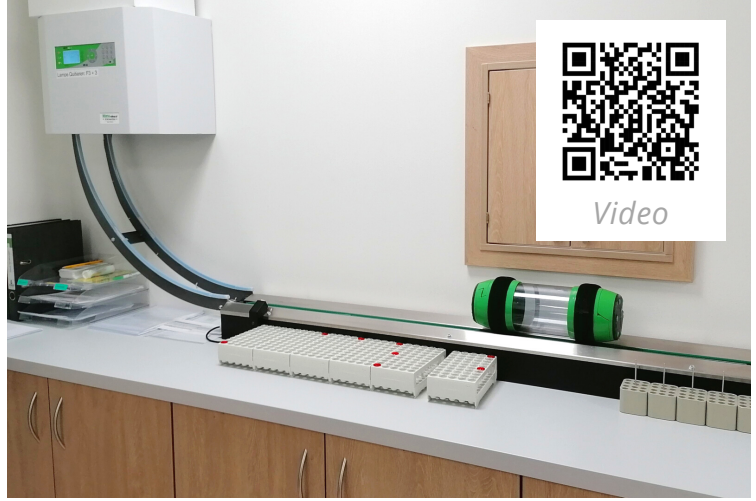
Förderband (installiert an Station 1.0222.T.02 mit Hörtig-Gehäuse)
